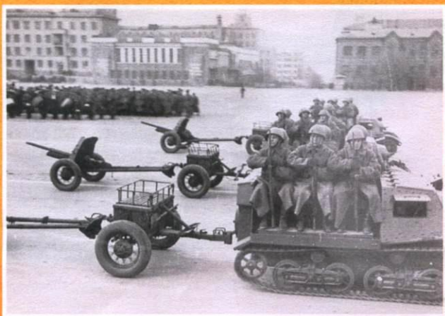
Тягачи «Комсомолец» с 45-мм противотанковыми пушками на параде в Куйбышеве. 7 ноября 1941 года
